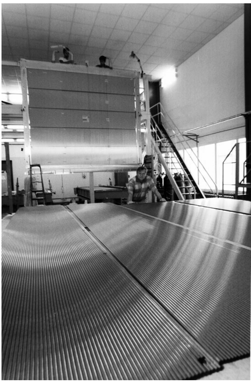
Строу-камеры для трека спектрометра COMPASS в процессе их сборки в ЛФЧ
