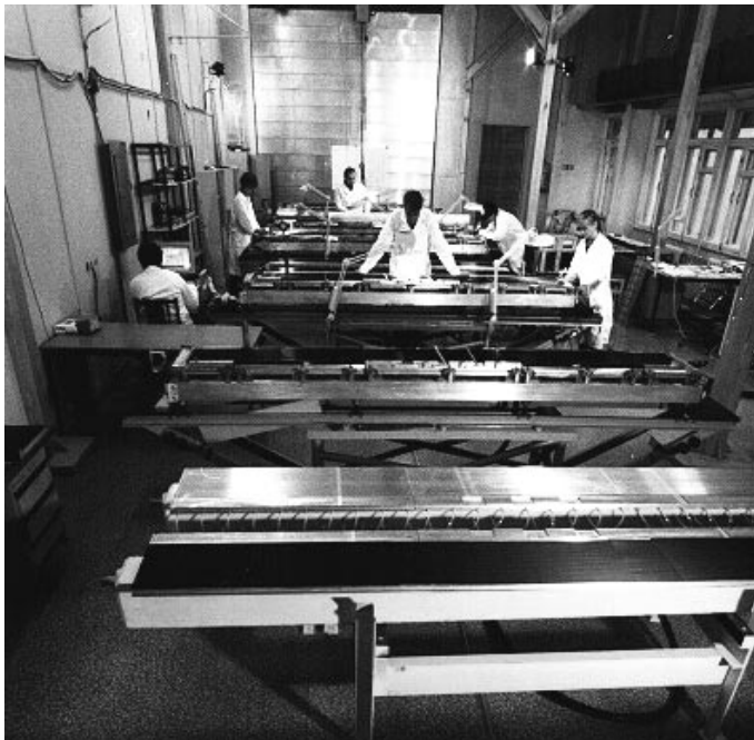
Линия массового производства дрейфовых камер внешнего трекера установки HERA-B
