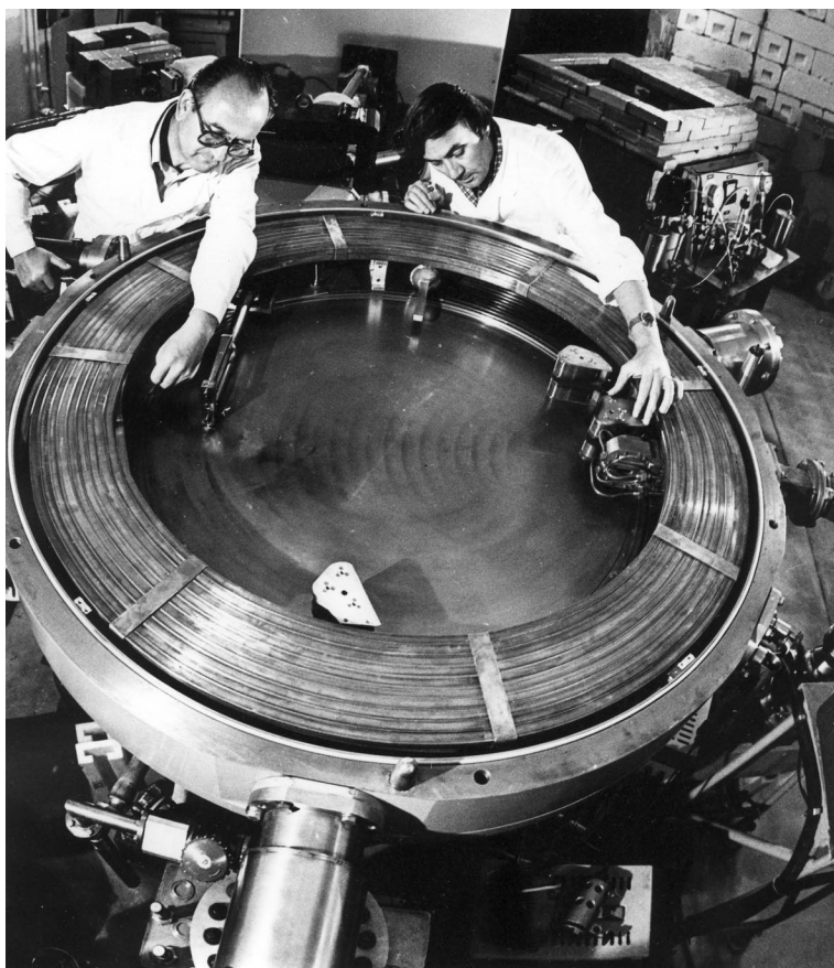
Камера микро- трона МТ-25 — ускорителя электронов
