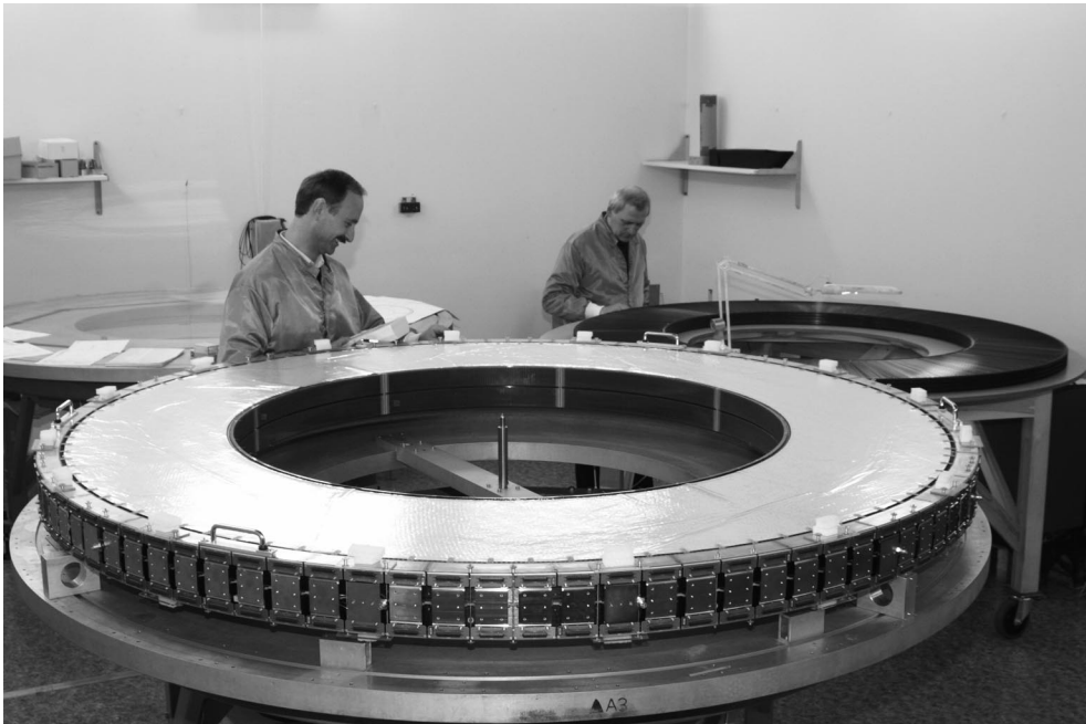
Первый (из 17-ти) восьмислойный модуль детектора переходного излучения TRT ATLAS тестируется перед отправкой в ЦЕРН
