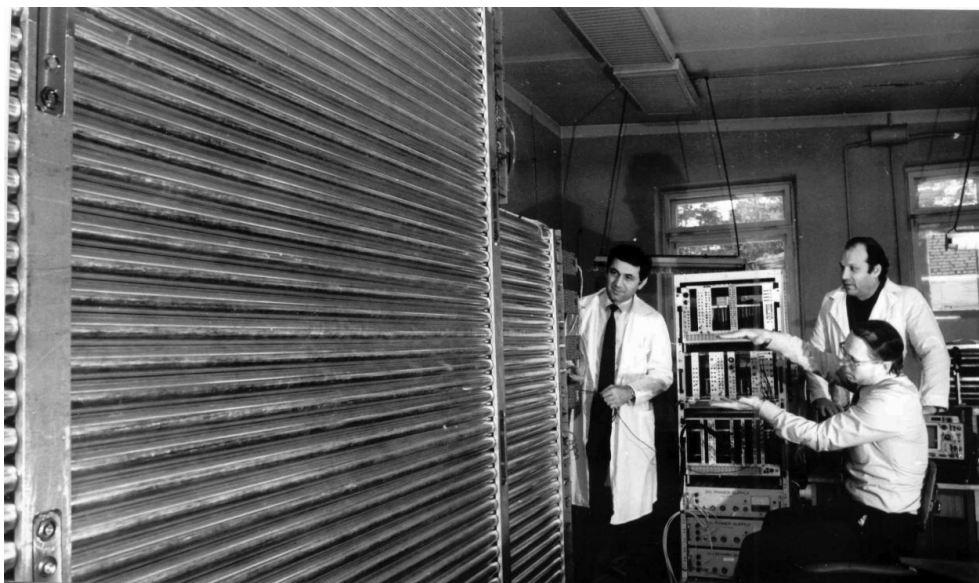
Дрейфовые трубки для мюонного спектрометра
