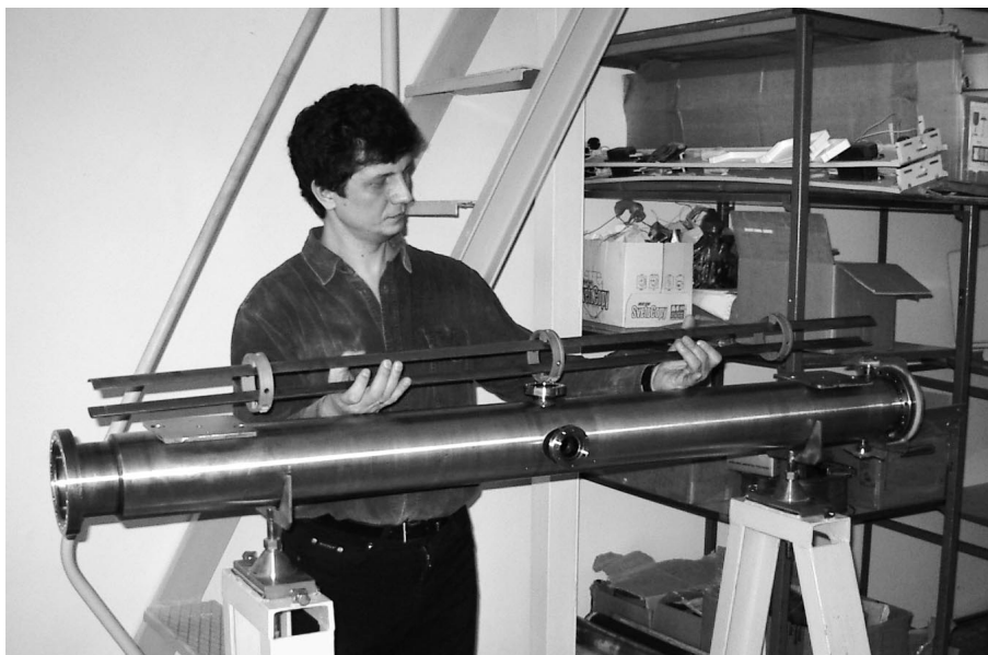
Монтаж электростатического дефлектора
