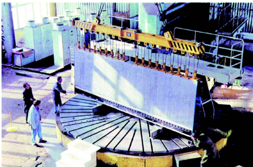
Рис. 9. Модуль-0 на шестиметровой планшайбе карусельного станка Лаборатории ядерных проблем ОИЯИ перед отправкой в ЦЕРН. Апрель 1996 г.
