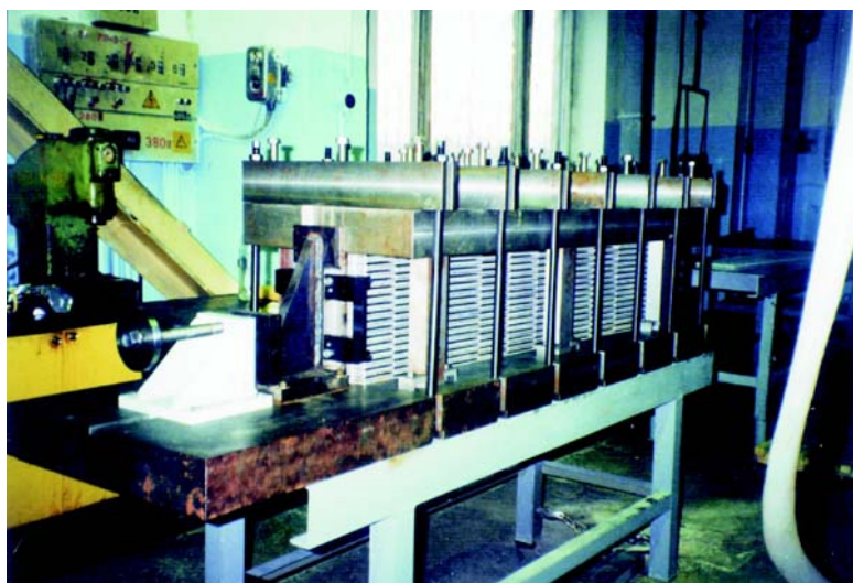
Рис. 5. Полимеризация субмодуля в специальном приспособлении (стапеле) под нагрузкой. Декабрь 1998 г. ОП ОИЯИ
