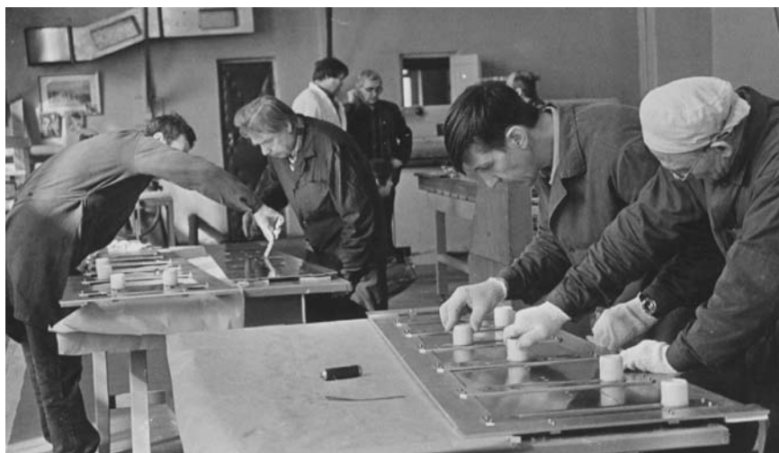
Рис. 7. Нанесение дозированного клеевого слоя в ЦОЭП ЛЯП. Март 1996 г.
