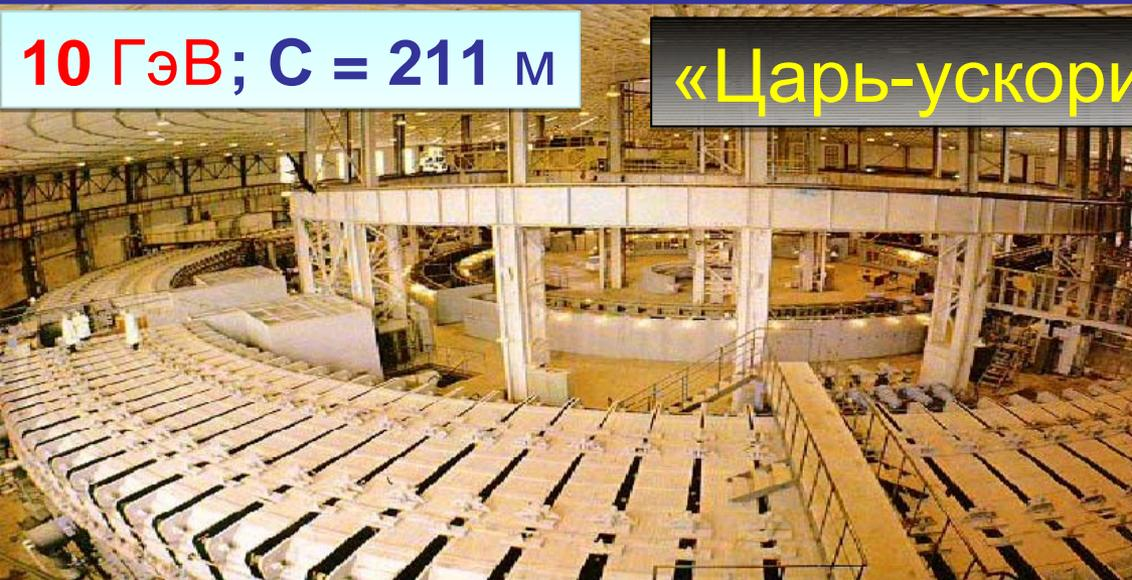
Синхрофазотрон был последним из Слабофокусирующих машин. Его магнит весит 36000 тонн
