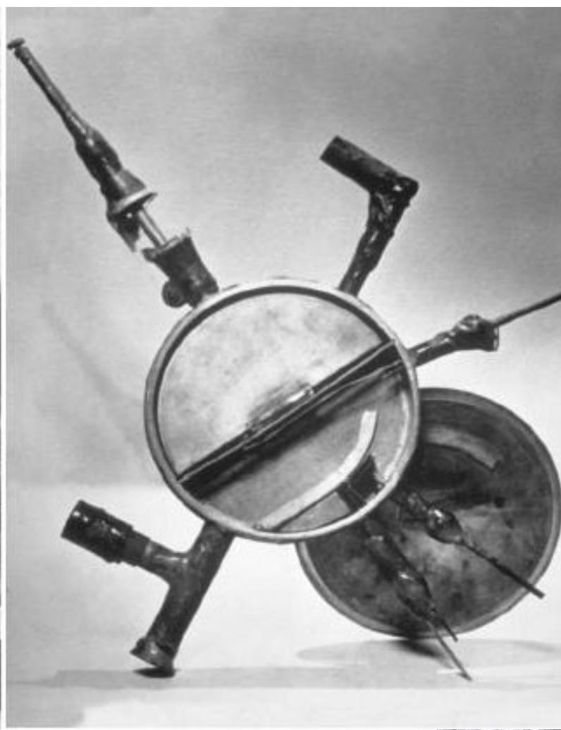
*Первый циклотрон, построенный Эрнестом Лоуренсом в 1931 году, умещался на ладони и разгонял протоны всего до 0,08 МэВ*
