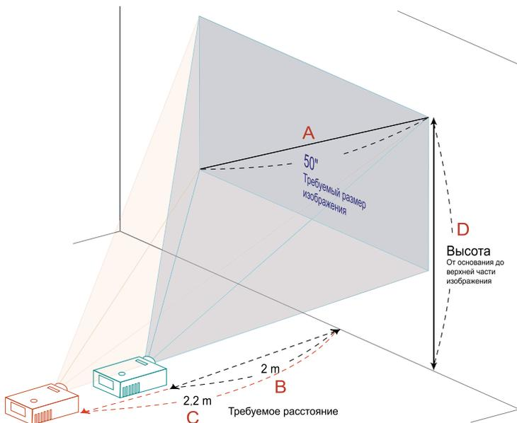
В приведенной ниже таблице показан способ достижения необходимого размера изображения посредством регулировки положения или кольца трансфокатора.
