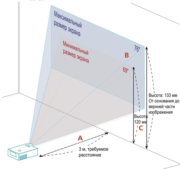
**Рисунок.** Фиксированное расстояние с различным масштабом и размером экрана. (Только для серии X1160Z/X1160PZ/X1260/X1260K, проекторы серии X1160/X1160P снабжены неподвижным объективом.)
