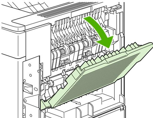
4. Извлеките задний выходной отсек. Сильно нажмите пальцем рядом с левым шарниром вправо, пока шарнирная ось не выйдет из отверстия внутри устройства. Поверните выходной отсек наружу и выньте его.
