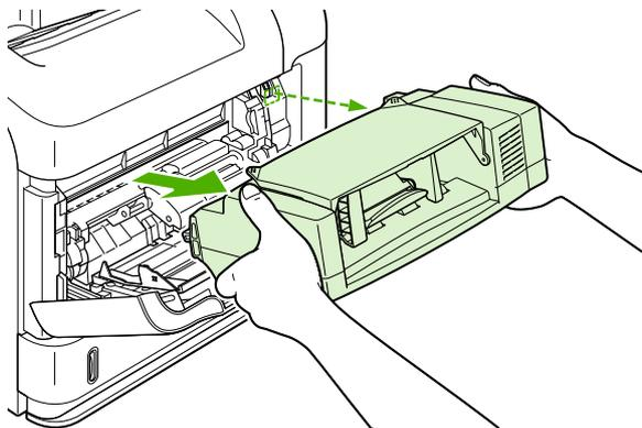
3. Аккуратно извлеките все замятые конверты из дополнительного устройства подачи конвертов и принтера.
