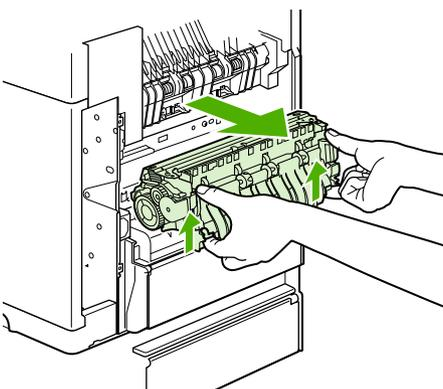
6. Извлеките застрявшую бумагу. При необходимости поднимите черную пластиковую направляющую в верхней части термоэлемента, чтобы достать замятый лист.
