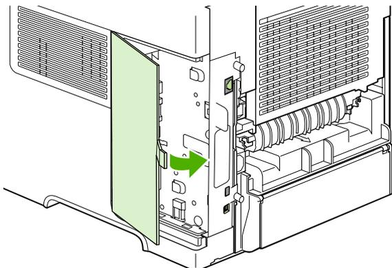
7. Установите правую боковую панель на место. Выровняйте выступы на панели с отверстиями в устройстве и задвиньте панель по направлению к передней части устройства до щелчка.
