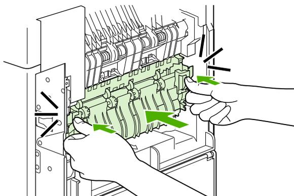
8. Установите задний выходной отсек на место. Вставьте правую шарнирную ось в отверстие внутри устройства. Вставьте внутрь левый шарнир и заведите его в отверстие внутри устройства. Закройте задний выходной отсек.
