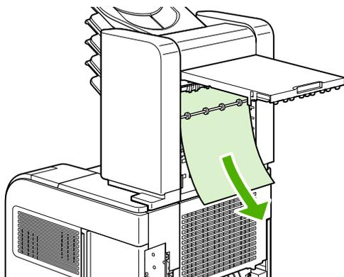
4. Если бумага застряла в нижней части приемника на 5 почтовых ящиков, откройте задний выходной отсек и вытяните бумагу прямо вверх.
