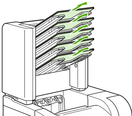
2. На задней части приемника на 5 почтовых ящиков откройте дверцу для доступа к замятой бумаге.
