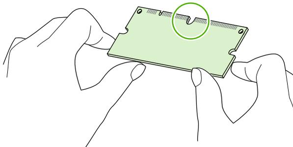
7. Вставьте модуль DIMM в гнездо (нажав до упора). Убедитесь, что зажимы на обоих концах разъема DIMM встали на место до щелчка.
