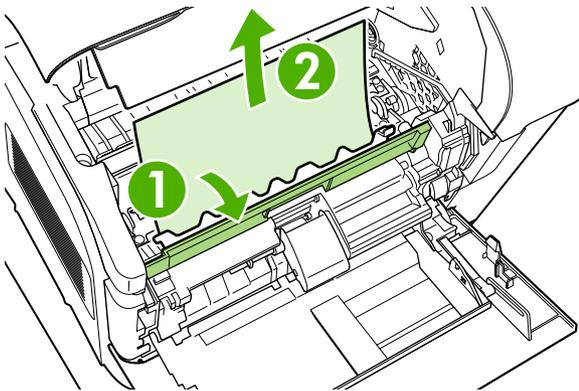
5. Установите крышку устройства подачи конвертов на место и закройте лоток 1.
