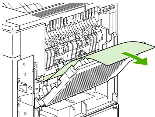
△ **ПРЕДУПРЕЖДЕНИЕ:** Не используйте острые или металлические предметы для очистки бумаги в области термоэлемента. Вы можете повредить термоэлемент.
