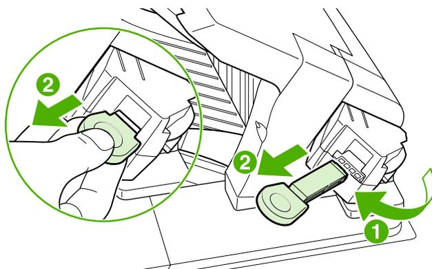
2. Вставьте новый картридж со скобками в устройство сшивателя и поверните сшиватель по направлению к задней части принтера.
