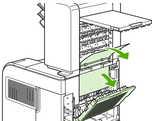
5. Закройте дверцу для доступа к замятой бумаге и задний выходной отсек.
