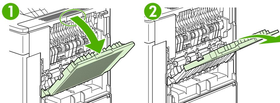
Открытие заднего выходного отсека приводит к отключению дуплексера (если он установлен) и верхнего выходного отсека. Во избежание замятия бумаги не следует открывать и закрывать задний выходной отсек во время печати.
