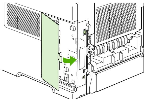
9. Установите правую боковую панель на место. Выровняйте выступы на панели с отверстиями в устройстве и задвиньте панель по направлению к передней части устройства до щелчка.
