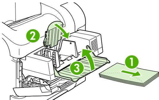
2. Возьмите дополнительное устройство подачи конвертов с двух сторон и осторожно вытяните его из принтера.
