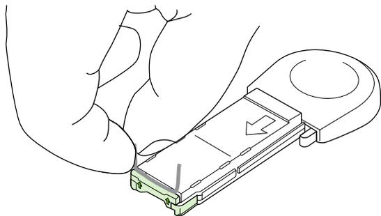
3. Вставьте картридж в модуль шивателя и поверните модуль по направлению к задней части устройства, пока он не встанет на место.
